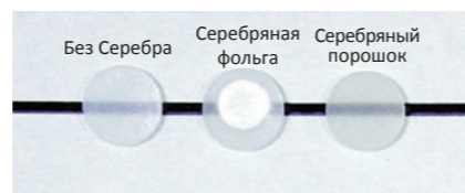
Тест на обесцвечивание прозрачных керамических масс
