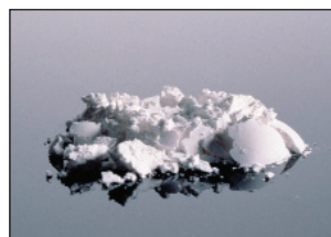
Обычный стеклоиномерный порошок при хранении иногда склеивается; таким образом, дозировка не всегда точная.
