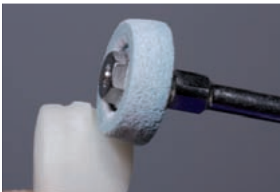
Загладьте точки присоединения литников на низкой скорости с небольшим давлением и проведите финишную обработку поверхностей
