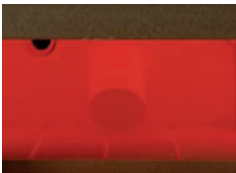
Установите опоку под наклоном к задней стенке отверстием вниз.
