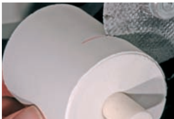
Надрежьте опоку с помощью сепарационного диска и разломите ее по сделанному надрезу.
