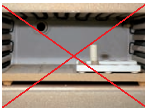
Не прогревайте заготовки IPS e.max Press и аллюмоксидный плунжер
