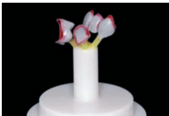
Законченная моделировка с литниками, установленная на 200 г муфельной системе
