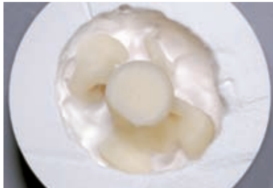
Черновая распаковка осуществляется стеклянной полировочной дробью под давлением 4 атм. (60 psi).
