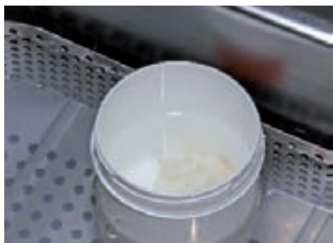
Удалите реакционный слой, образовавшийся на отпрессованных объектах, жидкостью Invex в ультразвуковой ванне.
