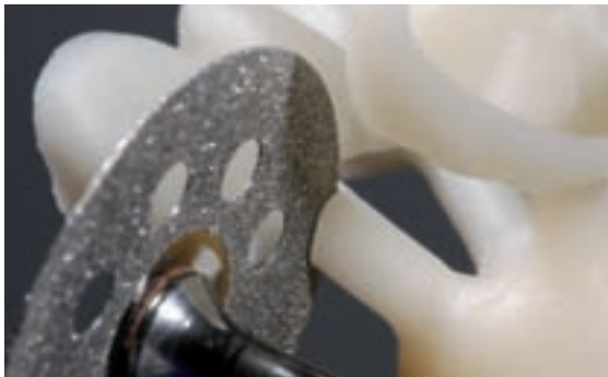
Отрежьте литники с помощью мелкозернистого алмазного диска
