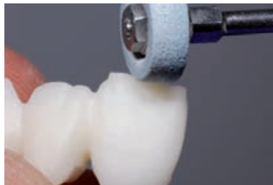
Загладьте точки присоединения литников на низкой скорости с небольшим давлением и проведите финишную обработку поверхностей
